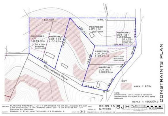
FIGURE 6 CONSTRAINTS PLAN - SLOPE
